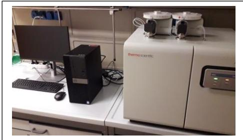
**Descrizione:** Analizzatore elementare operante in combustione dinamica del campione (metodo Dumas modificato) con modulo di controllo multi-valvola per la determinazione quantitativa di azoto, carbonio, idrogeno e zolfo, mediante pirolisi e separazione in colonna cromatografica.
